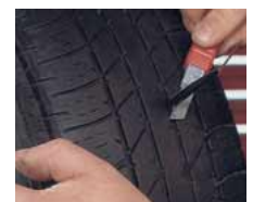
9. Կրկին մոնտաժելուց և փրչելուց հետո կտրել (առանց քաշելու):
